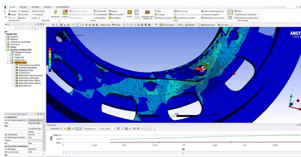
L'équipe effectue des **calculs hydrodynamiques** avec **Aqwa** sur la **structure globale du flotteur** afin de **mesurer**, en phase de conception, sa **capacité à résister à la pression des différentes vagues et aux efforts des lignes d'ancrage**. De nombreux cas de charge sont réalisés afin d'assurer la résistance du produit.
